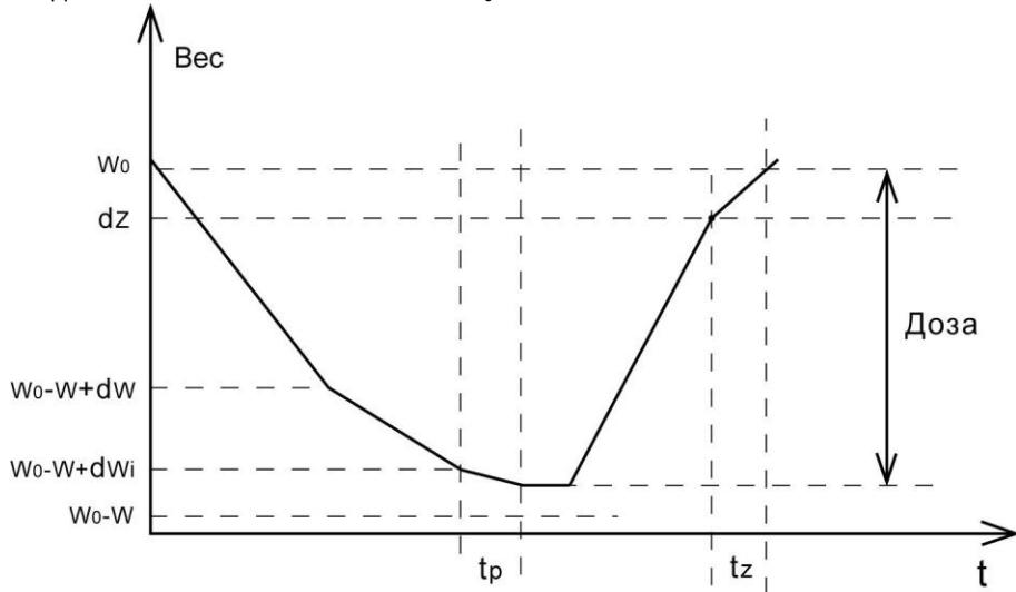
$W_0$  – Вес при начале дозирования,  $W$  - Вес дозы,  $W_0-W+dWi$  – «вес «точно»»,
