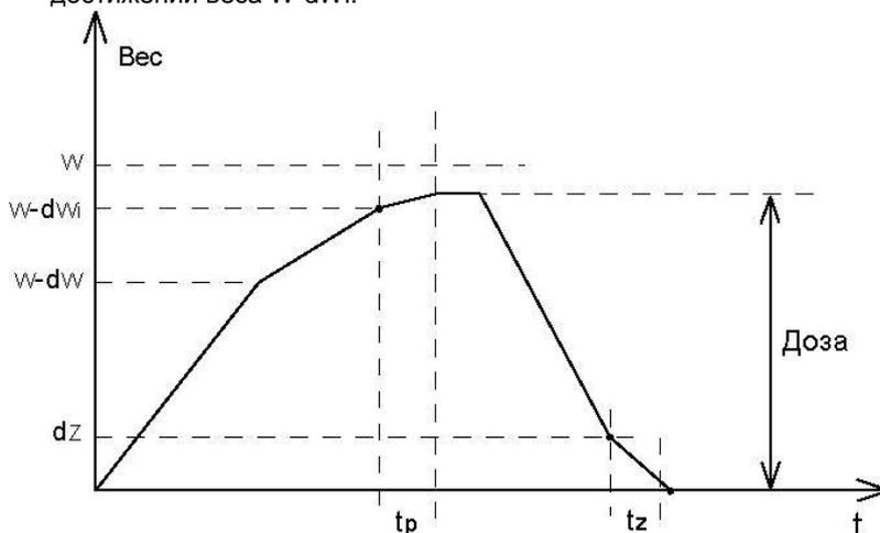
$W$  - Вес дозы,  $W-dWi$  — «вес «точно»,  $W-dW$  — «вес «грубо»,  $dZ$  — граница нулевого веса,  $t_p$  время успокоения системы,  $t_z$  — время установки нуля
