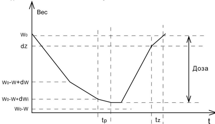
$W_0$  – Вес при начале дозирования,  $W$  – Вес дозы,  $W_0 - W + dWi$  – «вес «точно»,  $W_0 - W + dW$  – «вес «грубо»,  $dZ$  – граница нулевого веса,  $t_p$  время успокоения системы,  $t_z$  – время установки нуля
